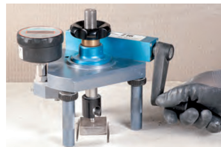
Merjenje oprijema (PULL OFF test)
