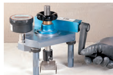
Merjenje oprijema (PULL OFF test)
