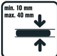
Debelina nanosa (vgradnje) v enem sloju od minimalno 10 do maksimalno 40 mm.
