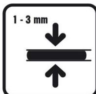
Debelina nanosa (vgradnje) v enem sloju od 1 do 3 mm.
