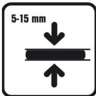
Debelina nanosa (vgradnje) v enem sloju od 5 do 15 mm.
