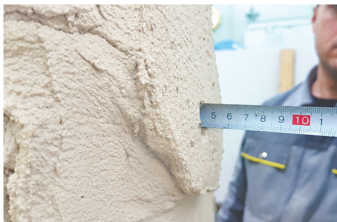
KEMASAN 550 MW omogoča lokalno nanašanje tudi v debelinah nad 4 cm brez lezenja materiala.
